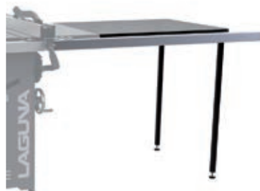
Erweiterung der Schnittbreite auf 1320 mm
