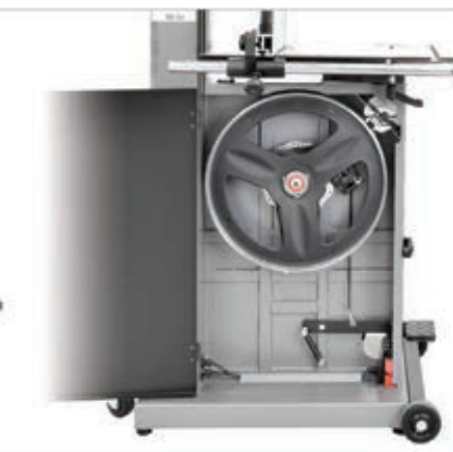
Scheibenbremse für schnelles Stoppen des Sägebands
