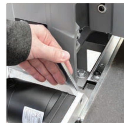
Hebel für Tischanheben beim Schleifen breiter Werkstücke
